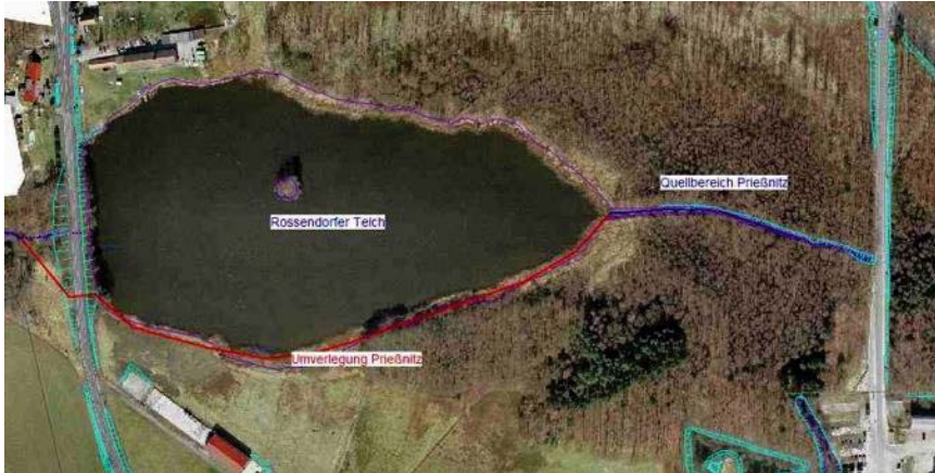
Abbildung: Umverlegung Prießnitz am Rossendorfer Teich (Quelle: Landeshauptstadt Dresden Umweltamt 2012)
