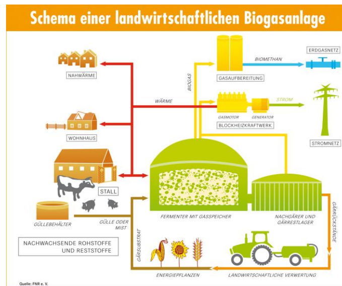
Abbildung 18: Schema einer landwirtschaftlichen Biogasanlage (FNR 2012a)
