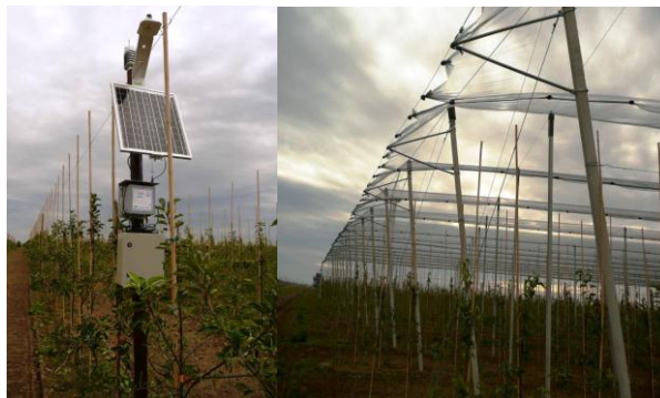
Abbildung 7: Wetterstation mit PAR-Sensor, Hagelnetzversuch Ablauf (Handschack 2010)
