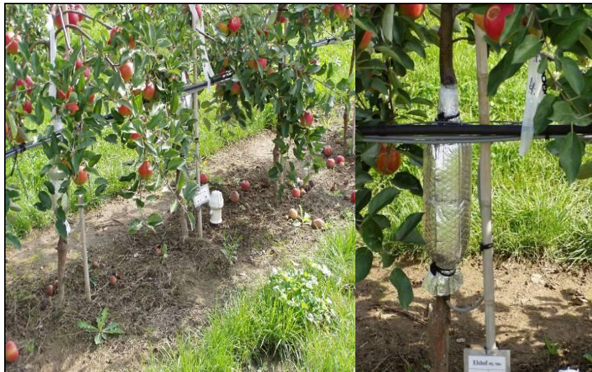
Abbildung 3: Messung der Bodenfeuchte und des Wasserverbrauchs (Saftstrom, Xylemfluss) (Handsack 2010)
