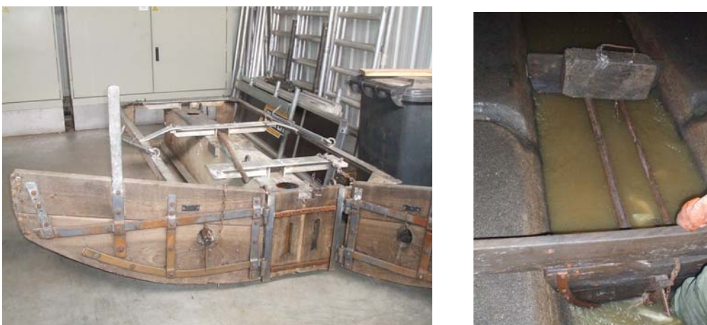
Abbildung 20: rechts: Dresdner „großer“ Stauwagen; links: „kleiner“ (links) Stauwagen (bei Reinigung der Trockenwetterrinne eines Bezirkssammlers)
