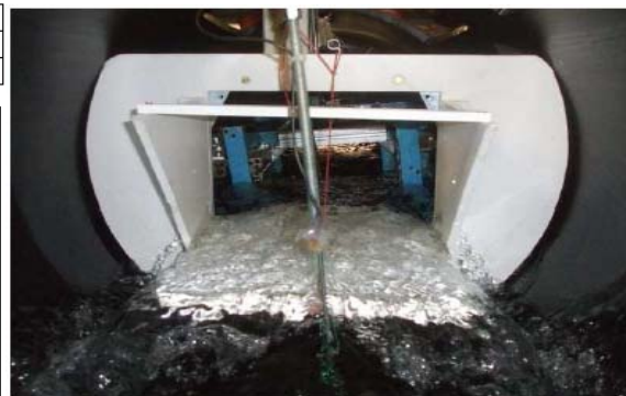
Abbildung 25: Verlauf der Ober- und der Unterwasserhöhe während einiger Klappvorgänge (links); Betrieb der Entlastungsklappe während der Entlastung (rechts)
