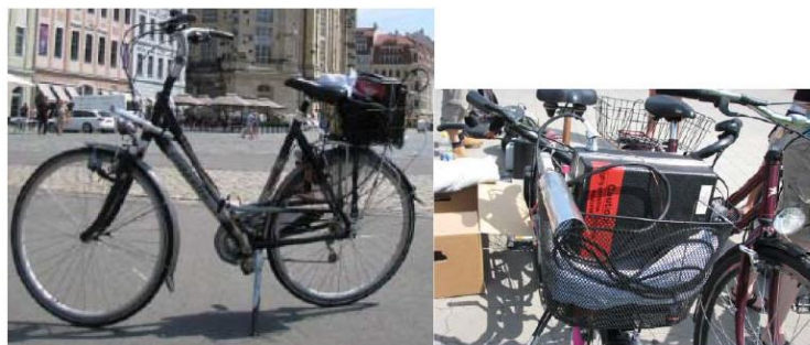
Abbildung 19: Messfahrrad mit installierten Messfühlern und Datenlogger
