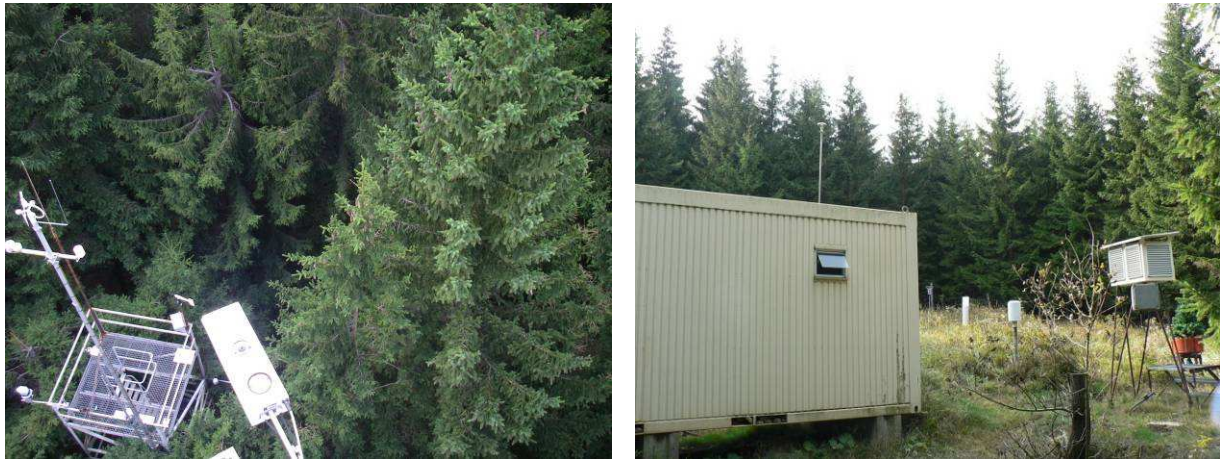
Abbildung 2: Forschungsstation Oberbärenburg. Links: 20 Meter Messturm in der Bestandsfläche. Rechts: Laborcontainer mit anisokinetischem Einlass für den 5-stufigen Berner-Impaktor auf der Freifläche.
